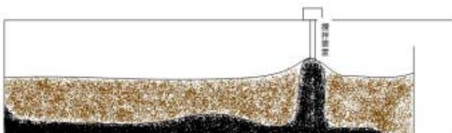
図4 発酵槽内部の炭化範囲 [ 黒い部分が炭化した部分 ] (断面)
